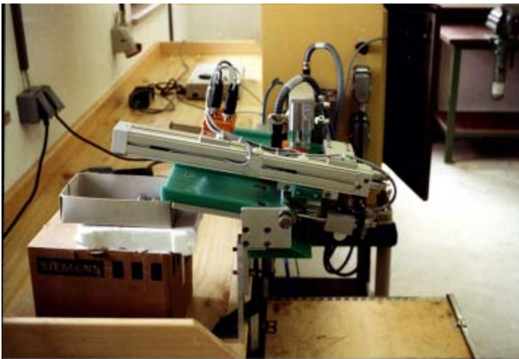
Blick auf die Teileabgabe i.O.-Teile
