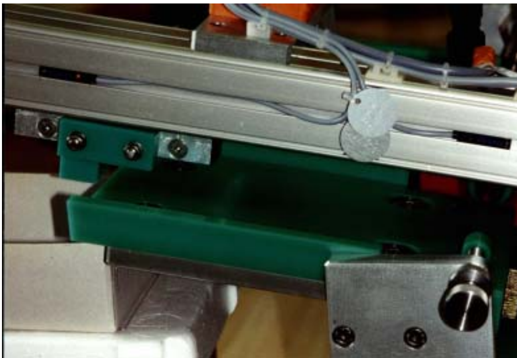
i.O.-Teil-Schieber in Auswurfposition (links), n.i.O.-Teil-Kanal ist geschlossen (rechts), neuer Prüfling in der Prüfspule (rot). O.K. parts slider in position "eject" (left), NOT O.K. output closed (right). Next test part inside coil (red).
