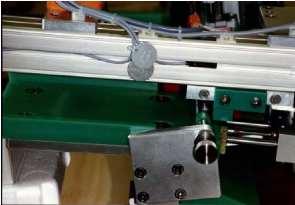
Geöffneter n.i.O.-Teil-Kanal. Das n.i.O.-Teil gelangt nach der Spule nach unten zur n.i.O.-Ausschleusung. NOT O.K. output open. Rejected parts reach NOT O.K. output after the test coil.
