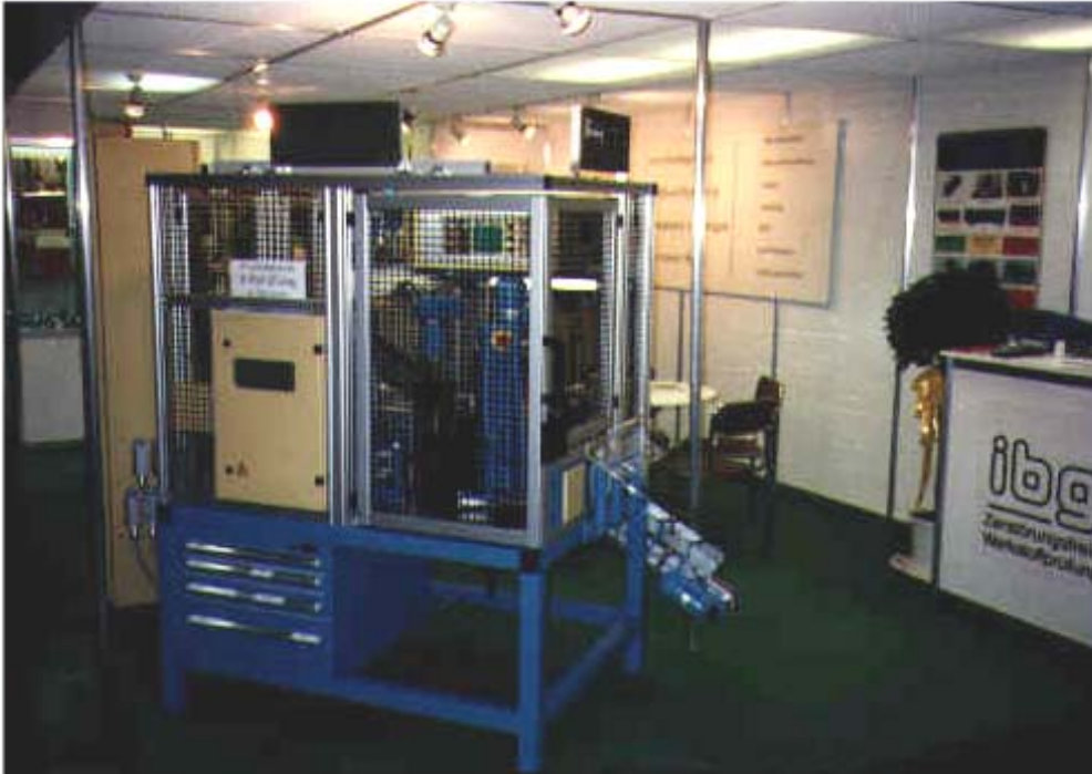
Gesamtansicht mit Schutzgitterzaun, Werkzeugschrank und Schaltschrank.
