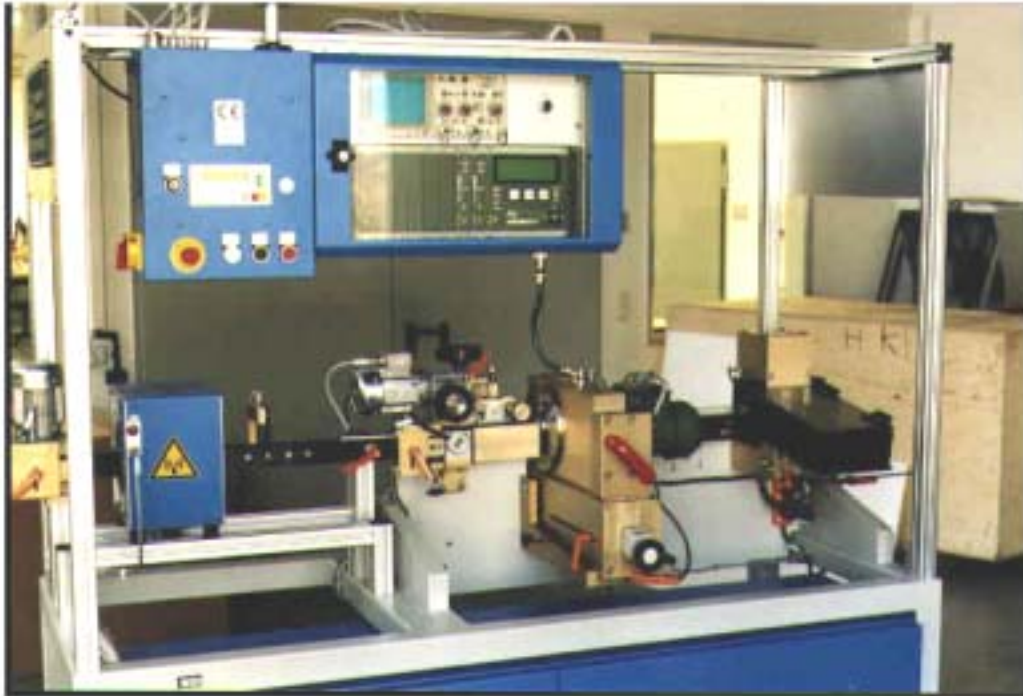
Einlauf, Entmagnetisierungsspule, Treibrollen, Rotierkopf eddyscan®H63 mit höhenverstellbarem Wartungsschlitten, verschließbare n.i.O.-Rutsche, i.O.-Auslauf.
