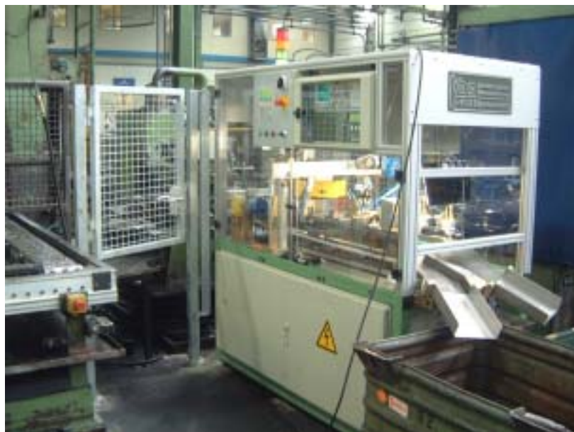
Gesamtansicht der Anlage mit Gut- und Schlechteilauslauf.
