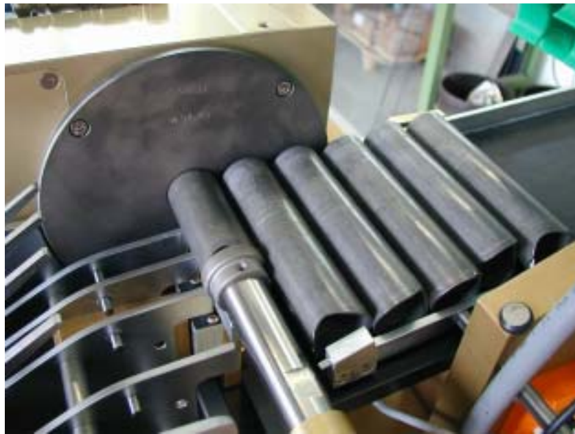
Prüfteile in der Teilezuführung zum Rotierkopf.
