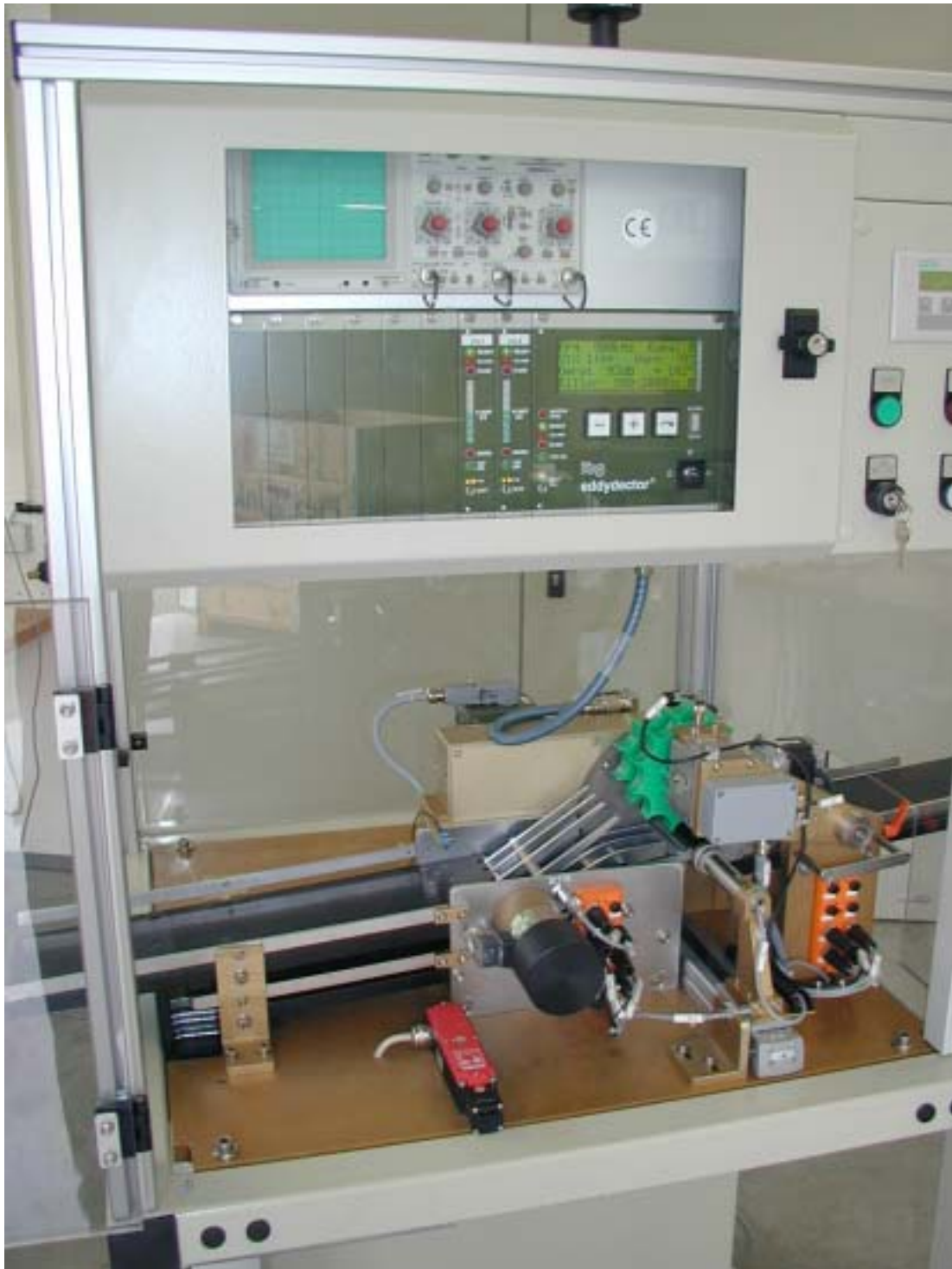
Gesamtansicht der Anlage mit Zuführrutsche, Vereinzelung, Rotierkopf eddyscan®H63, Abgaberutsche und Prüfgeräteschrank mit dem eddydetector® 2-Kanal.
