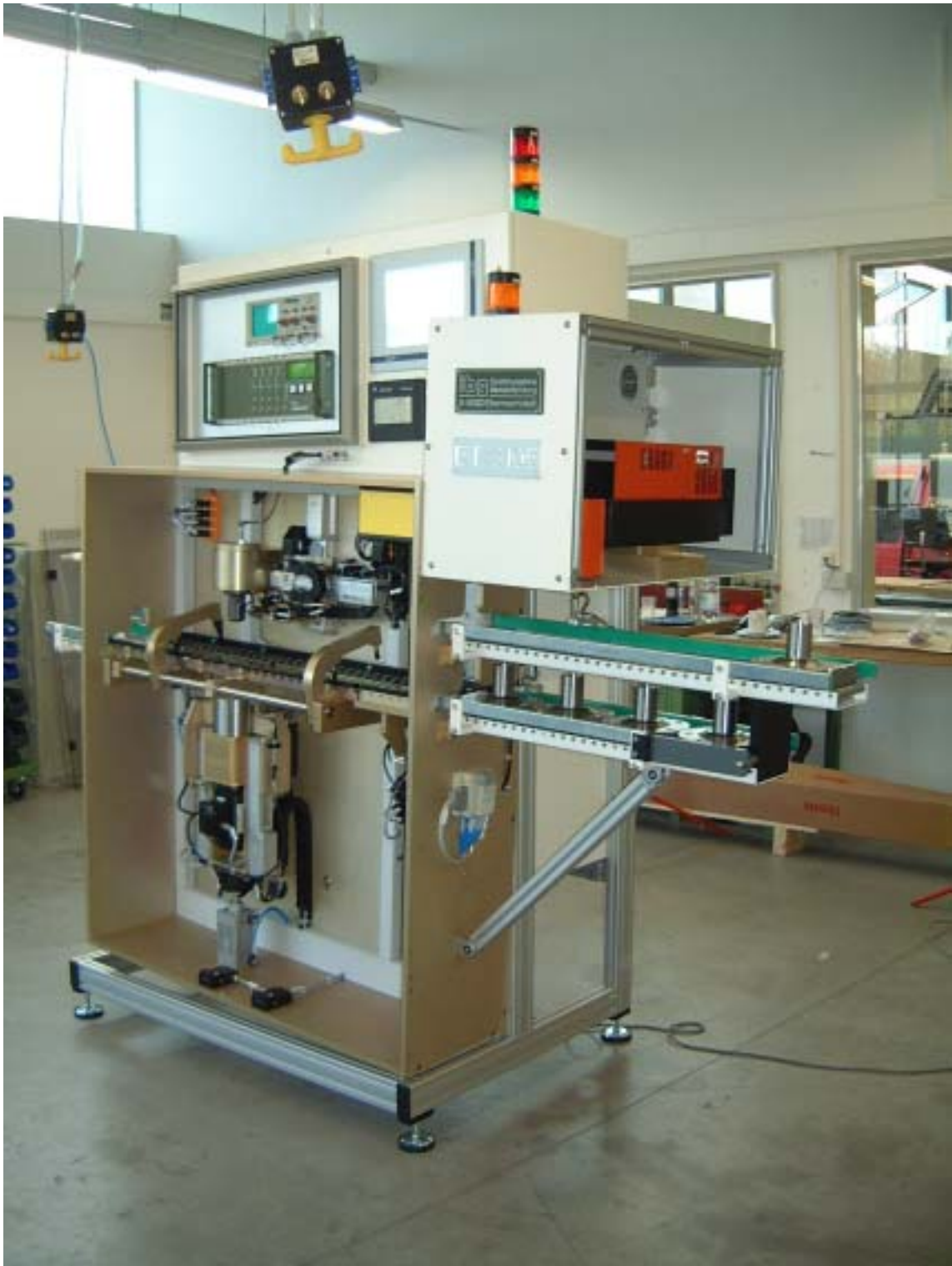
Gesamtansicht des Systems mit Teileinlauf über Rollenbahn von links, Prüfstation, Sortierung, Markierung und Auslauf.
