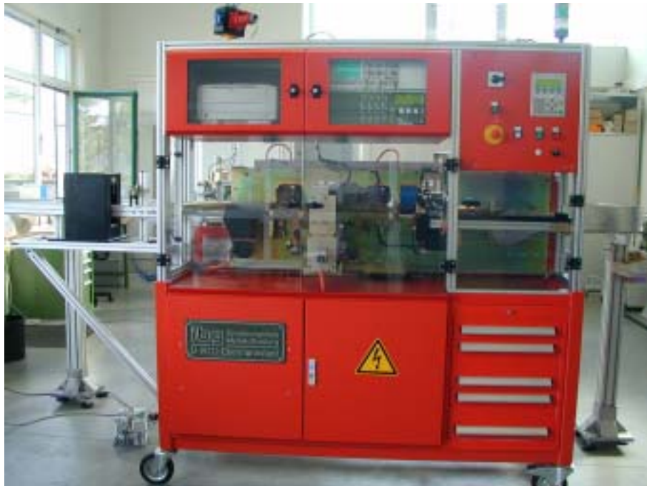
Gesamtansicht des Systems mit Teileeinlauf von links (mit Entmagnetisierspule), Rotierkopf, Sortierung und Auslauf.
