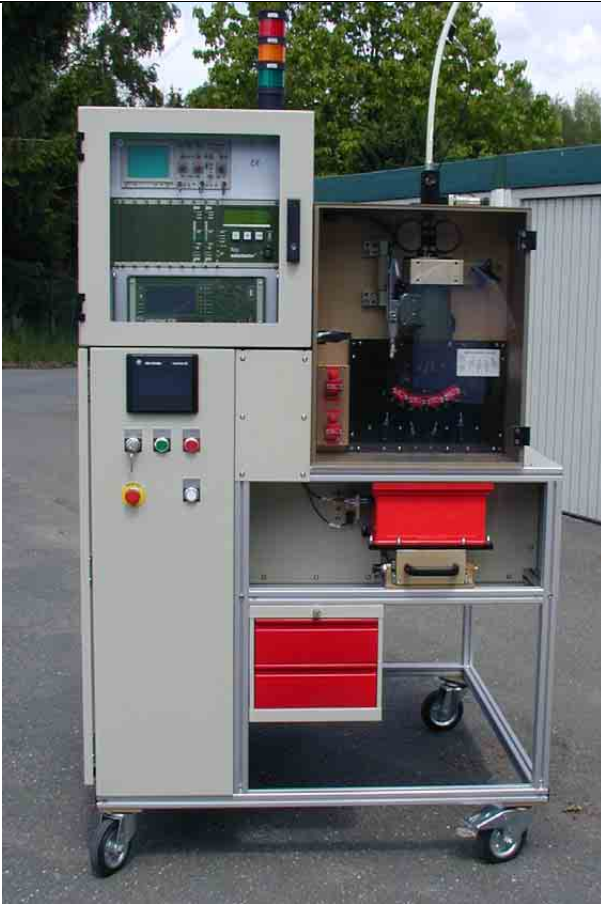
Gesamtmechanik mit Teileeinlauf (von oben), Rotierkopf eddyscan®H und die vier Prüfspulen des Quattrosorters.
