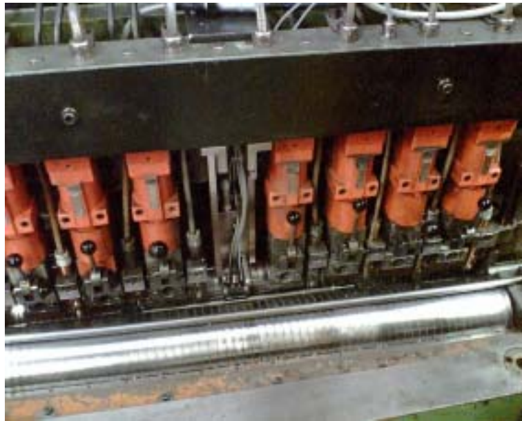
Prüfmodul mit Sonden und Einstellmechanismus.
